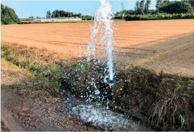
給水栓破損による漏水
